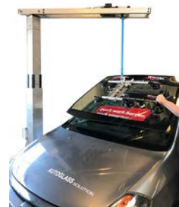
K4650 Scheiben-Lift für PKW / MKW 80 kg
